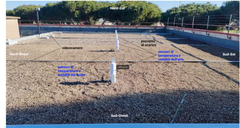
Figura 13 - Fotografia del campo prova del sistema BGR. È indicato l'orientamento nello spazio, la posizione delle due videocamere, i sensori per la temperatura e l'umidità dell'aria e del suolo.
