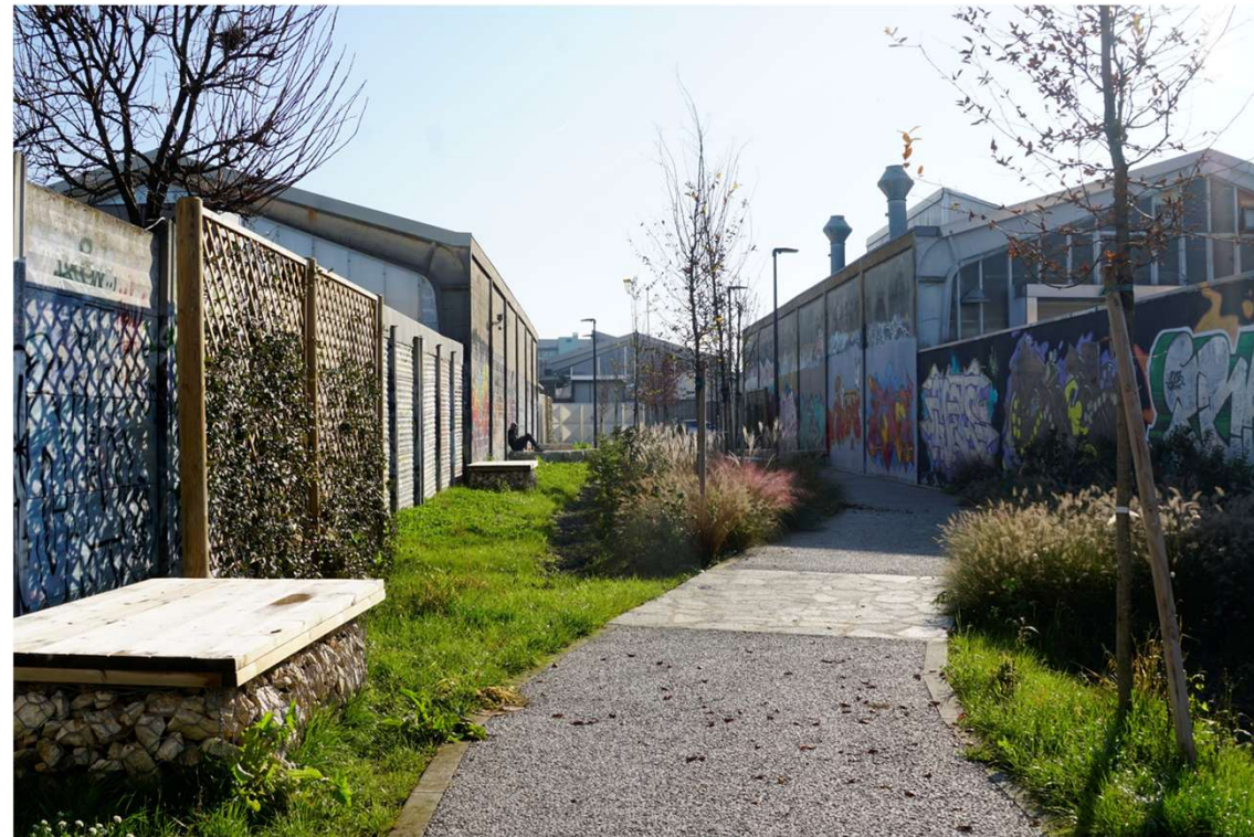
De-impermeabilizzazione di Via Prati a Trezzano sul Naviglio (vicino Milano). Uno degli interventi del grande progetto di "Sponge City" della Città Metropolitana di Milano ha cercato di ridurre il deflusso delle acque meteoriche rimuovendo la pavimentazione impermeabile di una piccola strada, che è stata trasformata in un'area permeabile dedicata al tempo libero .
