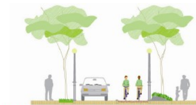
Imatge 40. Carril bici bidireccional (2,50m) segregat a un carrer interior de superilla.
