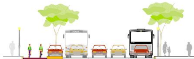
Imatge 38. Carril bici bidireccional (3,00m) segregat en calçada. Font: Elaboració pròpia.
