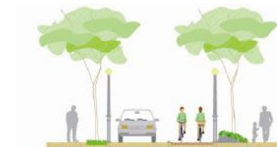
Imatge 40. Carril bici bidireccional (2,50m) segregat a un carrer interior de superilla. Font: Elaboració pròpia.
