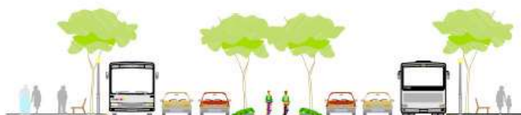
Imatge 39. Carril bici bidireccional segregat (3,00m) en passeig central. Font: Elaboració pròpia.
