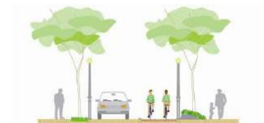
Imatge 40. Carril bici bidireccional (2,50m) segregat a un carrer interior de superilla. Font: Elaboració pròpia.
